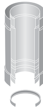
Doppelwandige Abgasleitung aus Edelstahl oder Kunststoff (Luft-Abgas-System)
